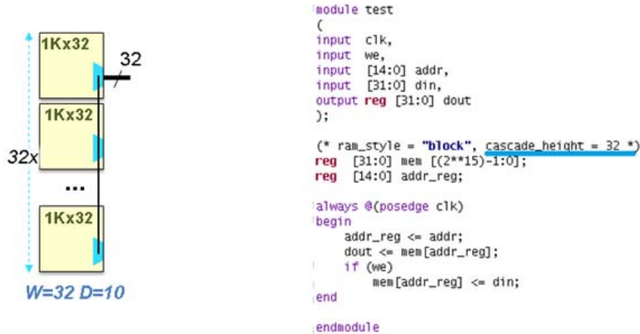
图 3-22：使用 1K x 32 和 CASCADE_HEIGHT=32 实现的 32K x 32 的 RTL 表达形式
