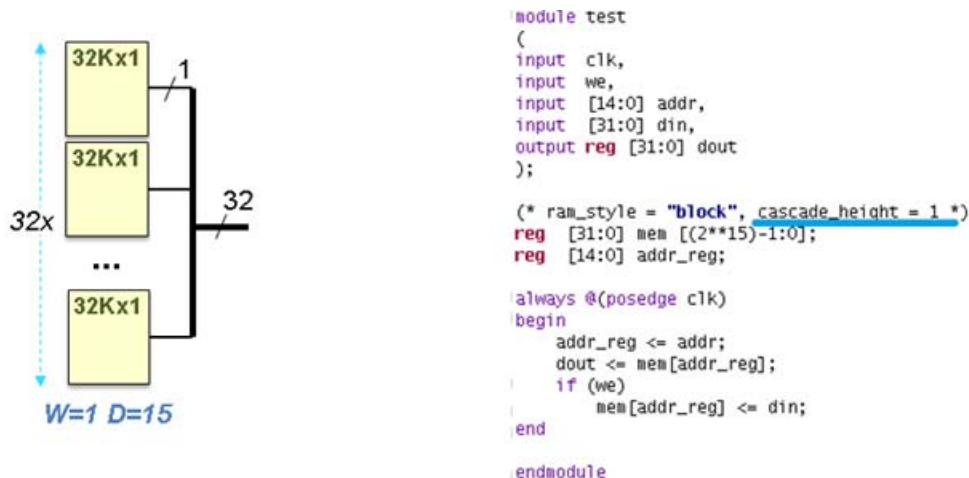
图 3-21：使用 1K x 32 和 CASCADE_HEIGHT=1 实现的 32K x 32 的 RTL 表达形式
